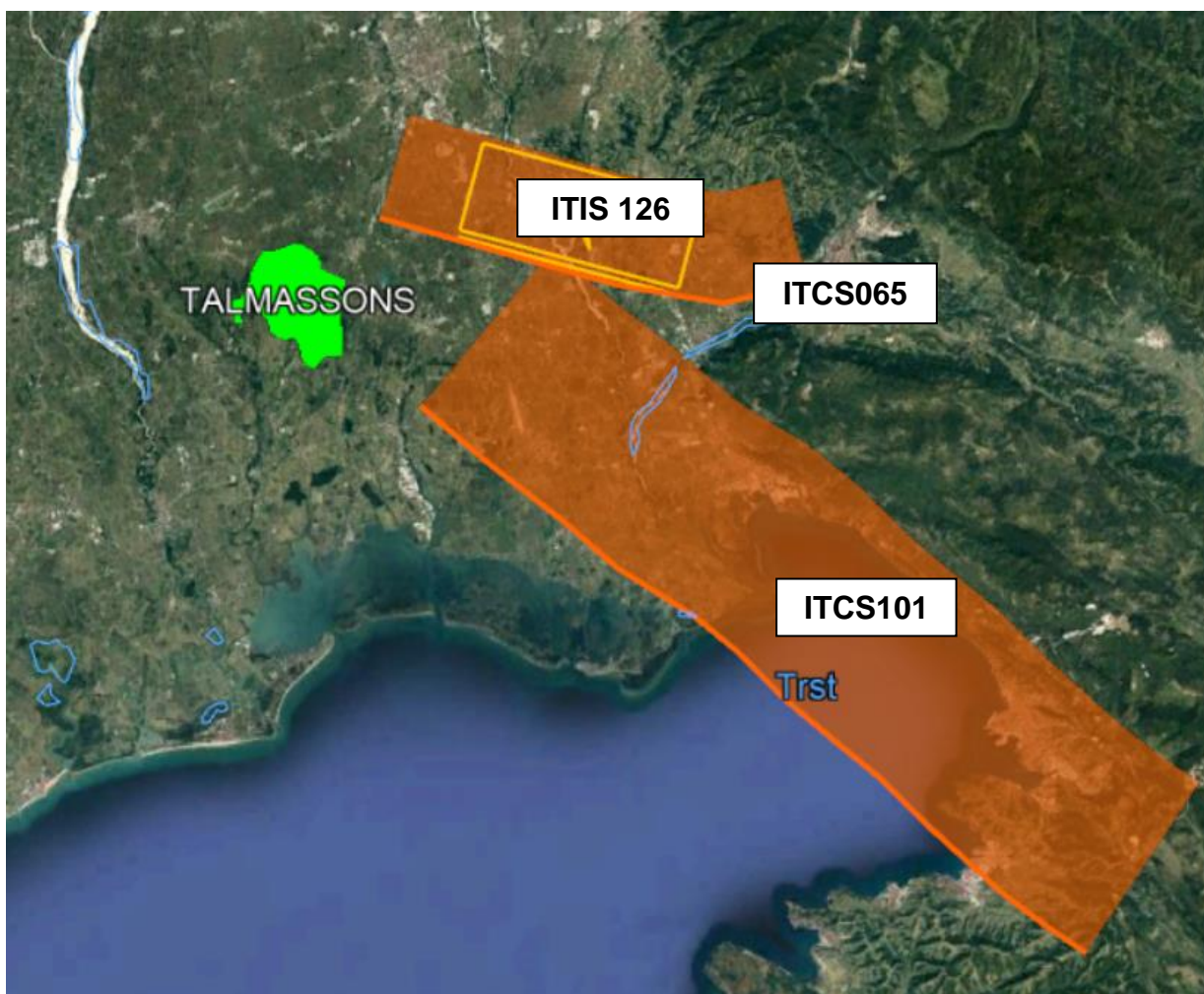
Fig. 12.0: Particolare relativo alle sorgenti sismogenetiche individuali e composite prossime all'area di studio (modificata da: INGV, DISS – Database of individual seismogenic sources); in verde il territorio comunale.
